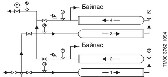
Блок из двух последовательно и двух параллельно включенных бустерных модулей, размещенных друг над другом.
