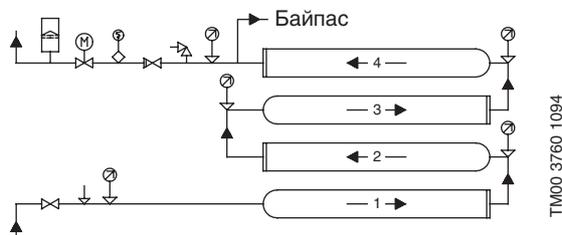
Блок из четырех последовательно включенных бустерных модулей, размещенных друг над другом.
