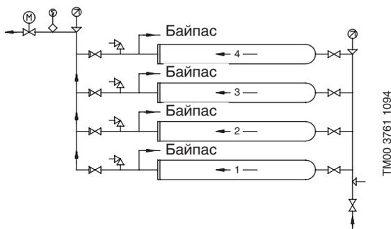
Блок из четырех параллельно включенных бустерных модулей, размещенных друг над другом.
