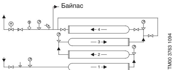
Блок из четырех последовательно включенных бустерных модулей с байпасной линией, размещенных друг над другом.
