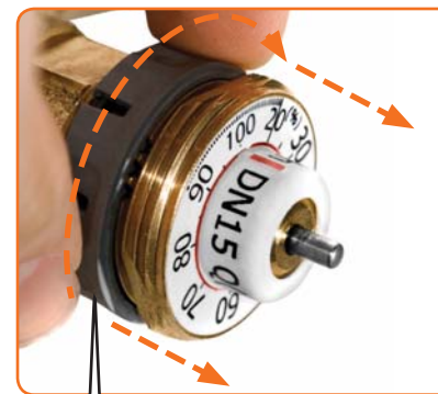
Поднять серое кольцо, поворачивая его, выставить требуемую проектную настройку
